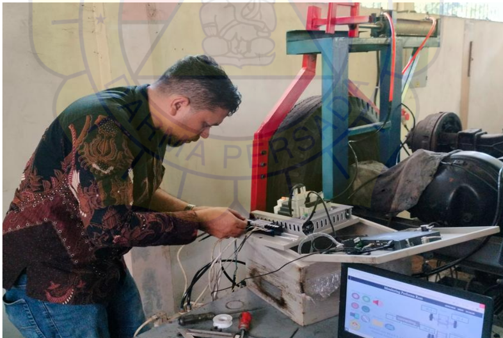
Proses Perakitan Panel Kontrol
