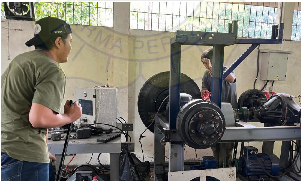
Proses Bleeding Minyak Rem
