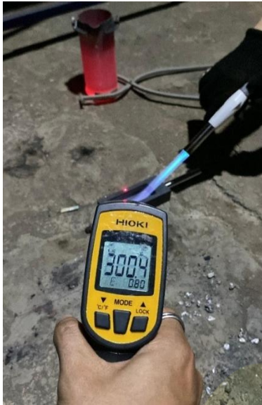
Pemanasan cetakan menggunakan gas torch hingga suhu konsisten di 300°C
