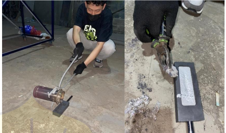
Penuangan logam cair ke cetakan yang sudah dipanaskan kemudian pembekuan logam
