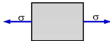
Gambar 2.13 Tegangan Tarik pada Elemen
