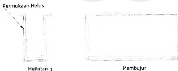
Gambar 2.4 :Cetakan Flume tank
