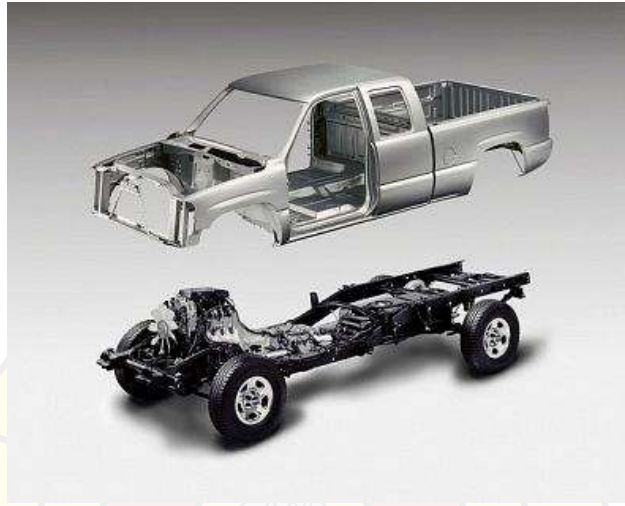
Gambar 2. 1 Body dan chassis kendaraan. [4]
