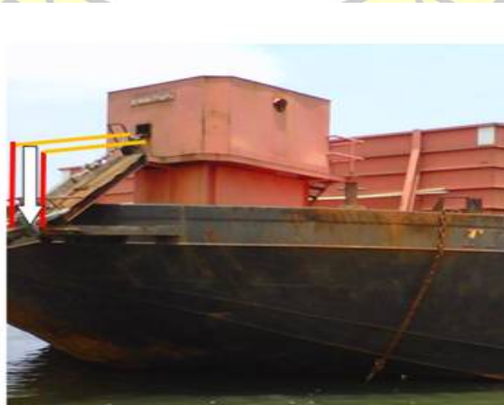
Gambar 3. Perubahan posisi jangkar dari rebah menjadi menggantung
