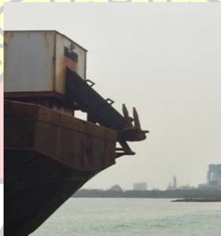
Gambar 2. Jangkar mulai naik ke posisi rebah
