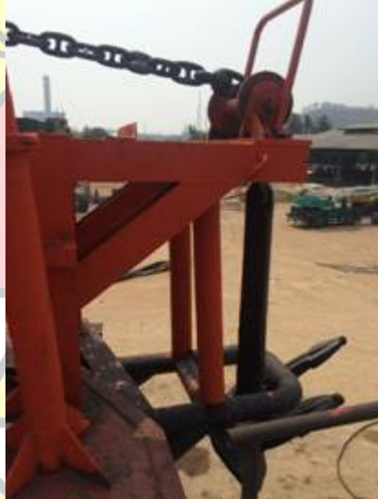
Gambar 7. Posisi jangkar setelah diubah
